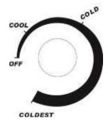
El control de temperatura mantiene la temperatura en el frigorífico. Configurar el control en
