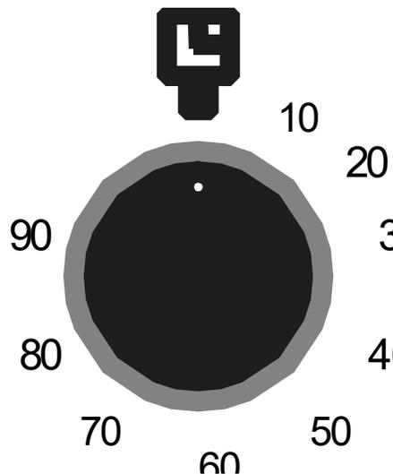
Nota: La alarma solo indica el final de cocción, no realiza el apagado del horno o cualquier otra función.
