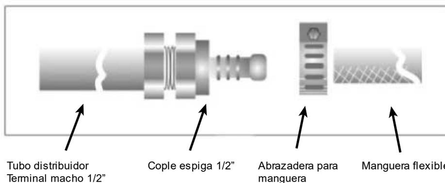
Si la instalación no es nueva limpie los tubos de cobre para evitar que se tapen las espreas (inyectores). Con el fin de facilitar el movimiento del horno, el instalador debe hacer una espiral con el tubo.
