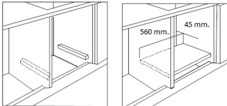
Deberá empotrar el horno levántelo de los costados cuidando que el cable de alimentación no quede atrapado, no levante el horno sosteniéndolo de la jaladera de la puerta.
