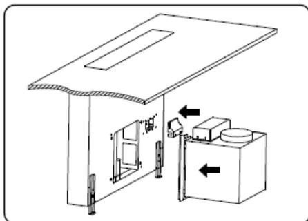
Retire los 4 tornillos que fijan el armado en el producto, conecte los cables, y coloque los tornillos que fijan la cubierta de la caja de control eléctrico
