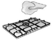
Para mantener limpios los quemadores y las parrillas deben **limpiarse periódicamente** sumergiéndolos en agua jabonosa y frotándolos con un cepillo no metálico con el fin de que agujeros y ranuras estén perfectamente libres para proporcionar una llama correcta. Seque las tapas de los quemadores y parrillas siempre que se haya mojado.
