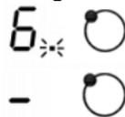
7. Cuando expire el tiempo de cocción, la zona de cocción correspondiente se apagar automáticamente. Otras zonas de cocción seguirán funcionando si están encendidas previamente.
