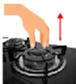
Para mantener limpios los quemadores y las parrillas deben limpiarse periódicamente sumergiéndolos en agua jabonosa y frotándolos con un cepillo no metálico con el fin de agujero y ranuras estén perfectamente libres para proporcionar una llama correcta.
