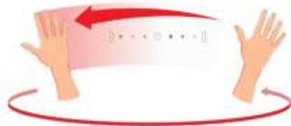
Para encender/apagar la luz, mantenga la mano sobre el sensor de gestos de luz durante 1,5 segundos.
