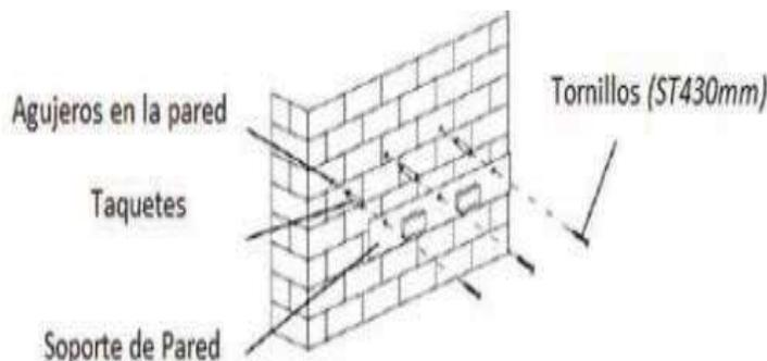
3. Instale los tornillos para madera. Fije e instale la placa colgante; después de colgar el cuerpo, use uno de los tornillos para pasar el tablero del final de carrera y evitar que caiga accidentalmente.
