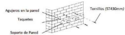
Para el modelo CP-90, es necesario perforar agujeros adicionales para los taquetes y tornillos de 4x8mm antes de la colocación del soporte.
