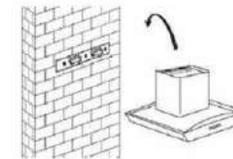
D) Fije la válvula unidireccional a la salida de aire de la campana. A continuación, sujete el tubo de escape a la válvula unidireccional como se muestra a continuación.
