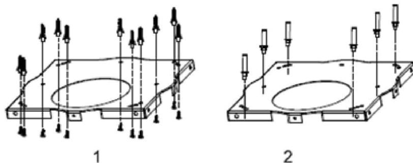
B) Fijar las barras de ángulo a la placa colgante, utilizando los tornillos 8XM5. Extienda las barras de ángulo a la altura requerida y luego fije en posición con los tornillos 16 XM5 y las arandelas de metal.
