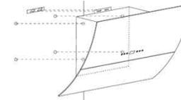
C) Coloque la campana sobre el gancho de soporte de pared.
