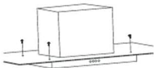
F) Levante el cuerpo principal de la campana de cocción en la barra de ángulo y fije en posición utilizando el tornillo 16 XM5.
